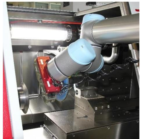
Fertigungszelle mit Roboter
