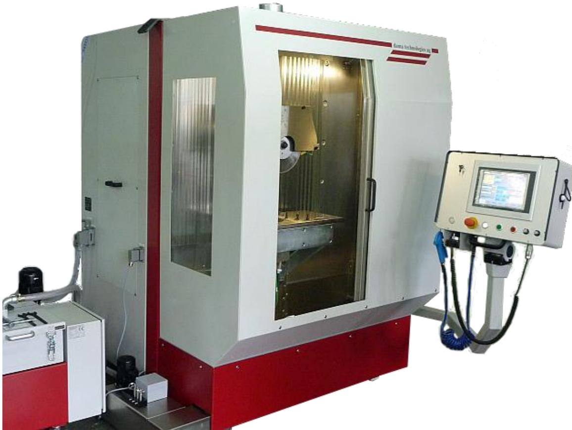
Die Maschine wird für die Bearbeitung von Glas- und Keramikwerkstoffen eingesetzt. Der Aufbau mit der horizontalen Schleifspindel ermöglicht den Einsatz als Trennschleifmaschine, Fräsmaschine oder als Planschleifmaschine. Die grosse Schiebetüre bietet ein angenehmes Arbeiten an der Maschine
